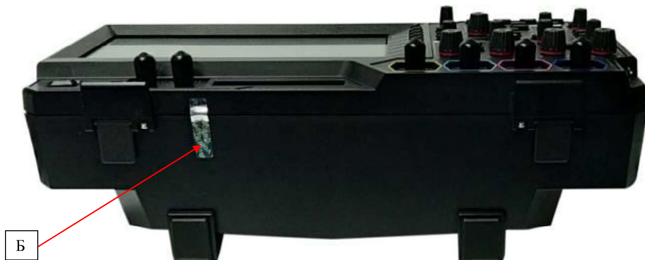
Рисунок 6 – Схема пломбировки от несанкционированного доступа (Б)
